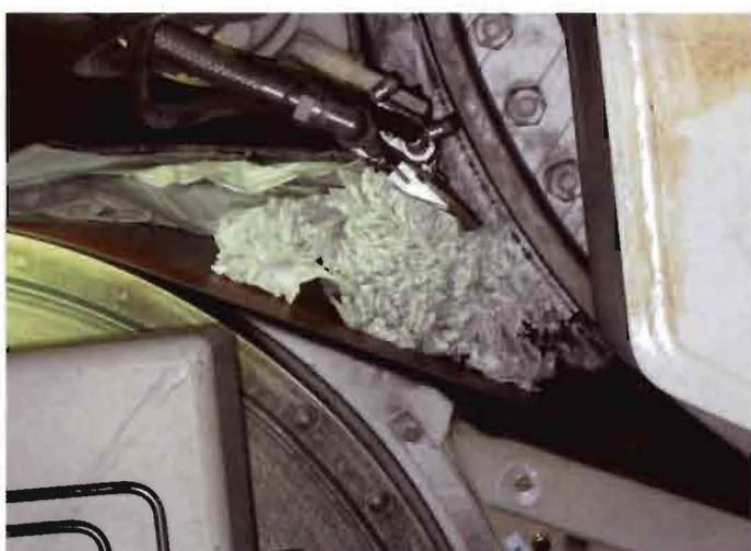
Abb. 6: Blade mit einem typischen „Wickler“ bzw. „Einpacker“
